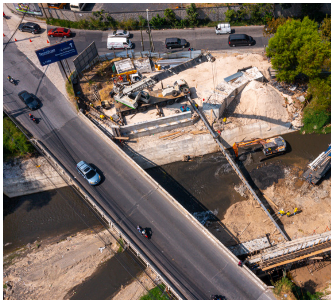
Instalación de vigas longitudinales en el Puente Tubac, Villa Nueva, Guatemala.
